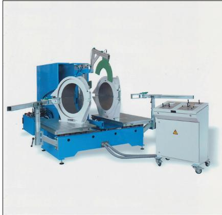
WIDOS 7000 WM mit geteilten Heizelementen und Ausleger zur Stahlrohrspannung.
