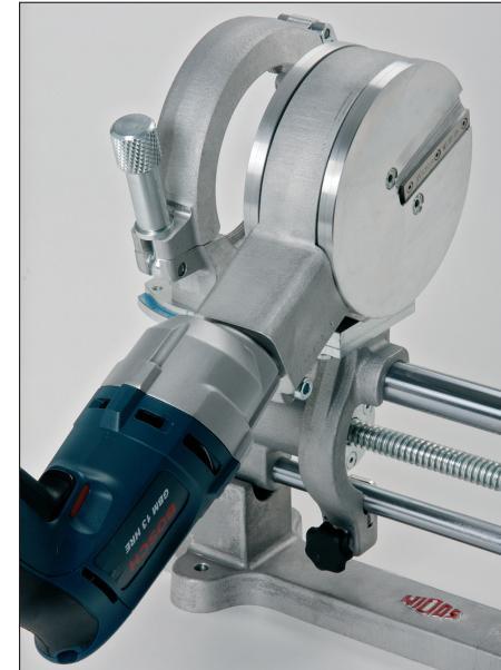
Rabot pour la Miniplast en version courte et longue, ou bien à mécanisme manuel (image gauche) ou bien en version électrique (image droite).
