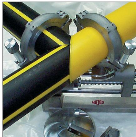
Um 45° geschwenkte Grundspannelemente mit Seiten- und Höhenverstellung, und zur Herstellung von T-Stücke 90°.
