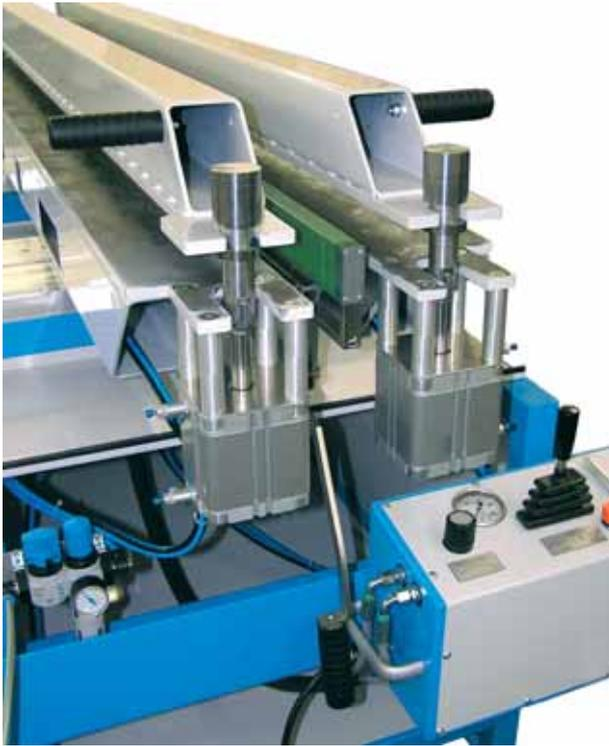
Pneumatische Spannung optional
