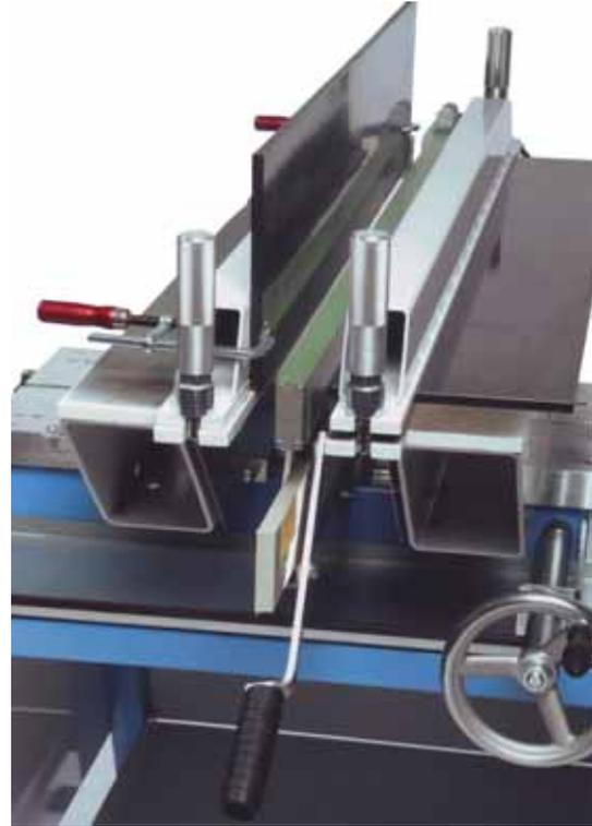
Spannen von Winkelstücken durch Vertauschen der oberen Spann-
